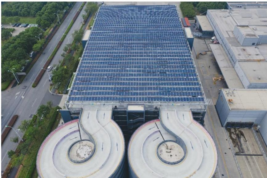
图 4：铺设于博世苏州停车楼的光伏电板
